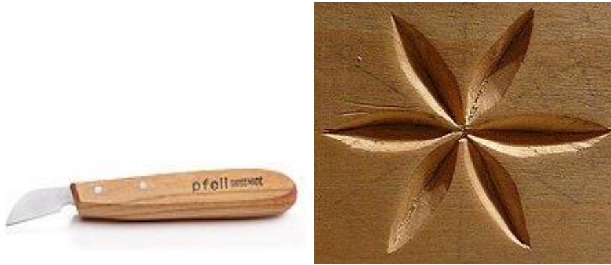
Kerbschnittmesser mit kurzer Klinge – eine mit dem Zirkel konstruierte Kerbschnittzrossette
